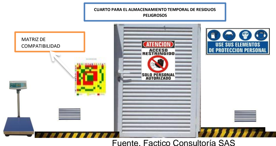
Figura 5. Condiciones de almacenamiento temporal de residuos peligrosos
