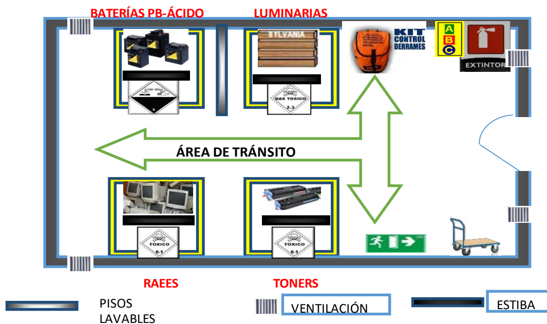
Figura 4 Condiciones de almacenamiento temporal de residuos peligrosos*
