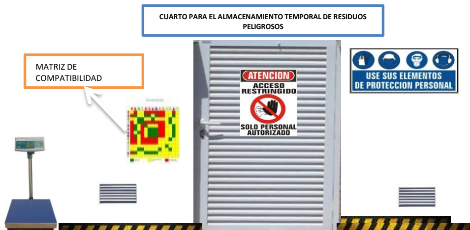
Ilustración 2. Señalización en el sitio de almacenamiento temporal de residuos peligrosos.
