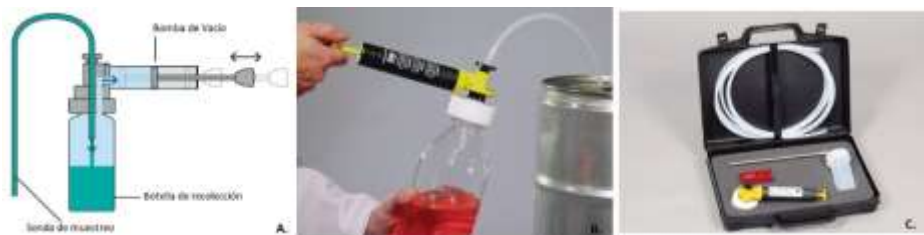
Figura 1. A) Funcionamiento del MiniSampler de PTFE. B) MiniSampler de PTFE en uso. C) MiniSampler de PTFE en estuche
