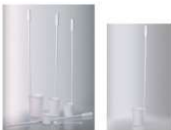
Figura 5. Cuchara para muestreo en PTFE
