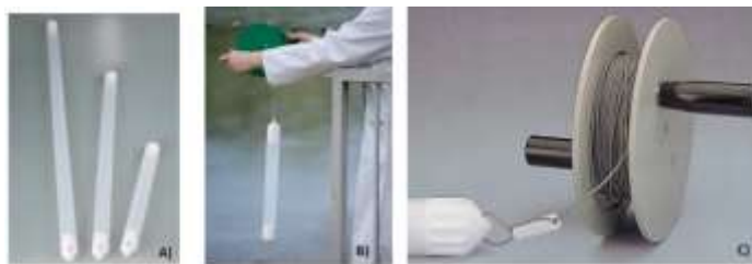
Figura 3. A) Aqua Sampler. B) Operación del Aqua Sampler. C) Bobina de cable manual
