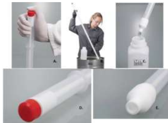
Figura 4. A) Manejo del pulsador. B) Operación del LiquiSampler. C) Vaciado de la muestra. D) Botón de presión. E) Cabezal de succión
